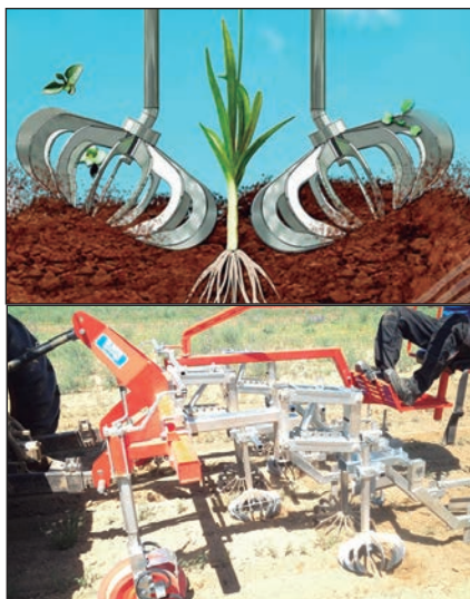
Rotores binadora Rotosark.
