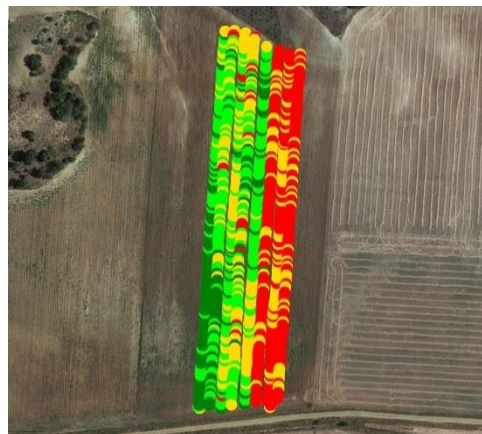
Control del índice de vegetación (NDVI) mediante sensores y mapas de vigor del cultivo
