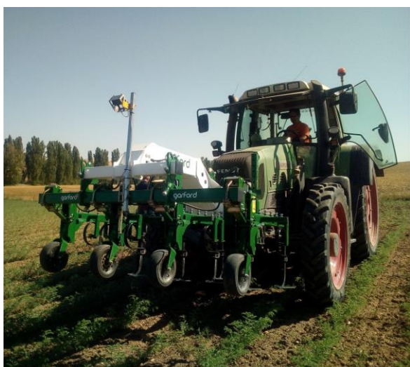
Apero Robocrop montado sobre el tractor
