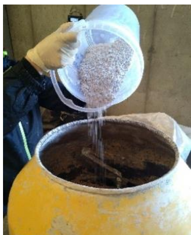
Inoculación de semillas en hormigonera
